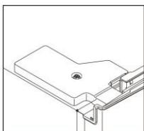
12 Anslut dörrkontakten och bildskärmskontakterna och installera det övre vänstra gångjärnskåpan.
