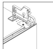
2 Ruuva irti oikean yläsaranan kansi ja irrota ovikytkimen ja näytön liittimet.
