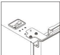
11 Montera det övre gångjärnet på vänster sida, justera det övre gångjärnet något under installationen för att säkerställa att tätningen är mycket tät.
