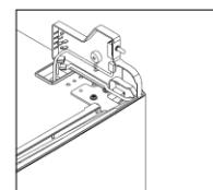
2 Skruva av locket på det övre högra gångjärnet och koppla loss kontakerna på dörrkontakten och displayen.
