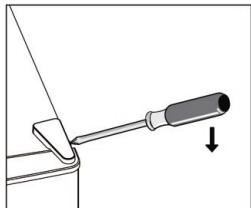
2. Skruva ut skruvarna. Avlägsna där efter gångjärnsfästet.
