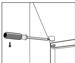
4. Flytta täcklocket från vänstra till högra sidan. Lyft där efter övre dörren och placera den på en vadderad yta för att undvika repor.
