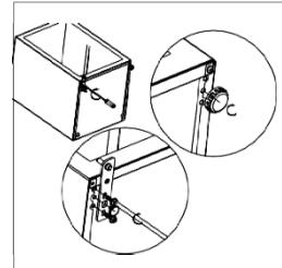
7. Sätt tillbaka kylskåpets dörr. Säkerställ innan det övre gångjärnet dras fast att kylskåpsdörren är inriktad horisontellt och vertikalt så att tätningsarna sluter tätt runt hela dörren.
