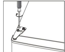
10. Sätt tillbaka gångjärnslocket och skruvlocket.
