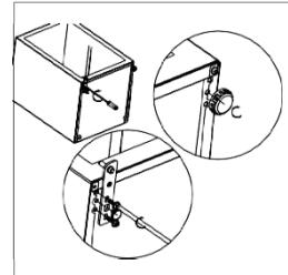
7. Asenna ovi takaisin paikoilleen. Varmista ennen yläsaranan lopullista kiristämistä, että ovi on säädetty vaaka- ja pystysuunnassa niin, että tiivisteet sulkevat ovet kaikilta puolilta.
