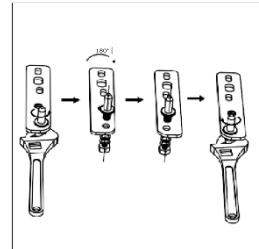
6. Laita alasaranan pidike uudelleen paikalleen. Laita säädettävä jalat paikoilleen.
